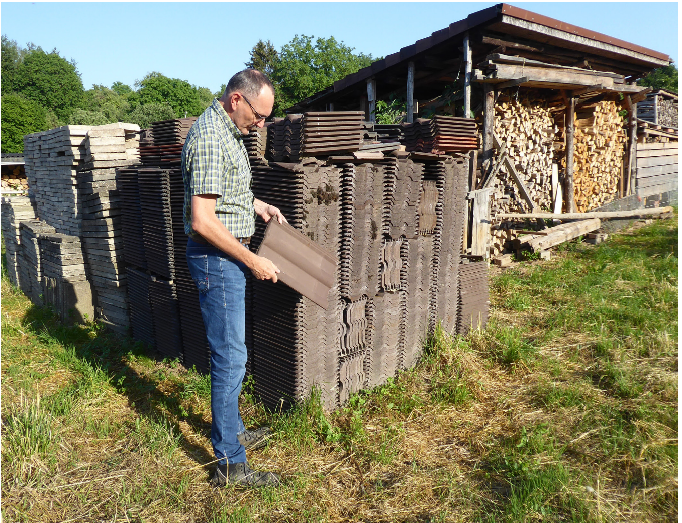
4.02 Geborgen und sauber gelagert eignen sich viele Baumaterialien wie Platten und Betondachsteine sehr gut für eine Wiederverwendung
